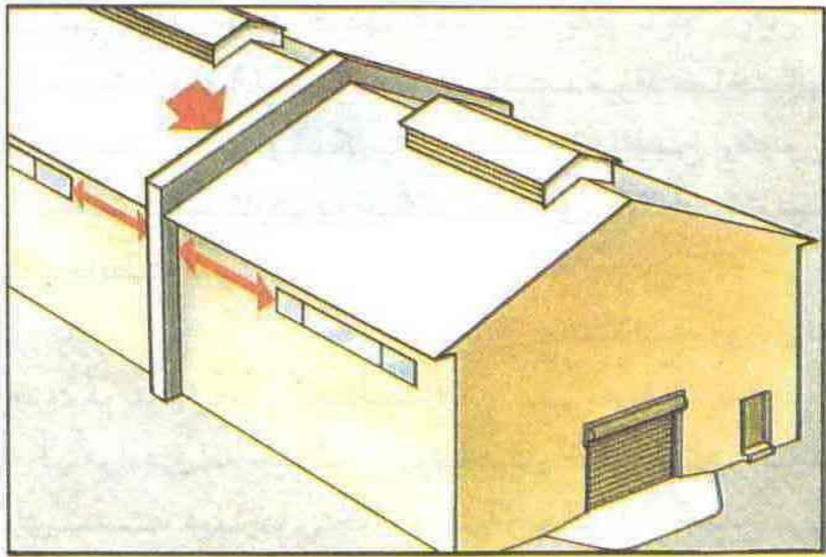
دیوارهای جدا کننده مقاوم در برابر آتش از درون سقف امتداد می‌یابند.
